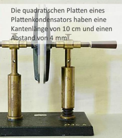
Wie groß (in F oder nF) ist die Kapazität C des Kondensators ?
