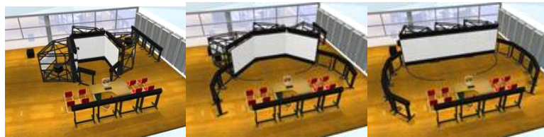
Abbildung 2: 90°-, 135°- und 180°-Setup des VR-Systems
