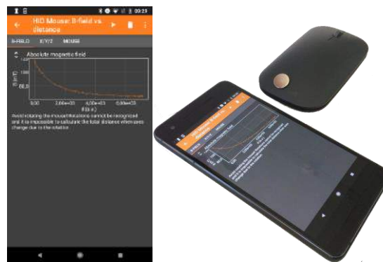
Abb. 2: Bluetooth Low Energy Maus mit Magnet zur Messung der Abstandsabhängigkeit des Magnetfelds eines Magneten.
